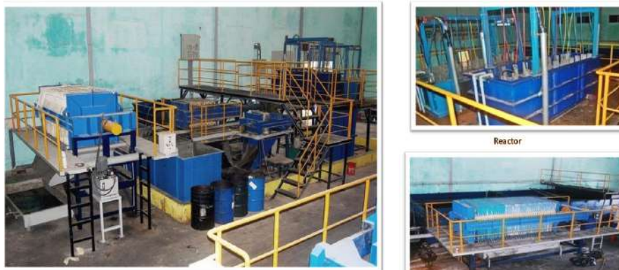
Gambar 4.10 Pengolahan Limbah Cair dengan Electrocoagulant
