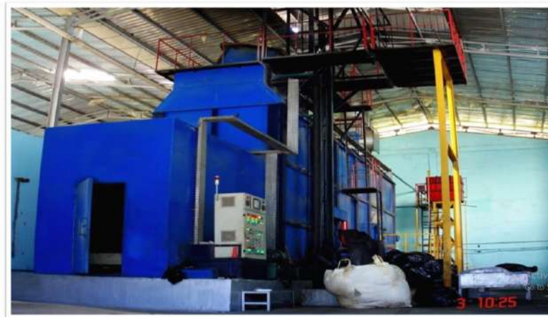
Gambar 4.11 Pengolahan Limbah Padat dengan Incinerator
