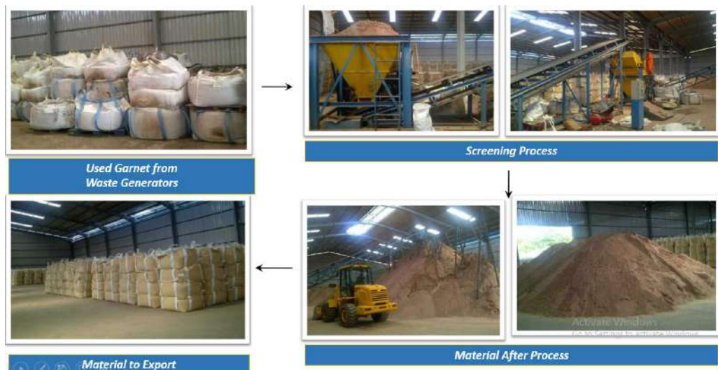
Gambar 4.13 Pengolahan Limbah Padat dengan Screening
