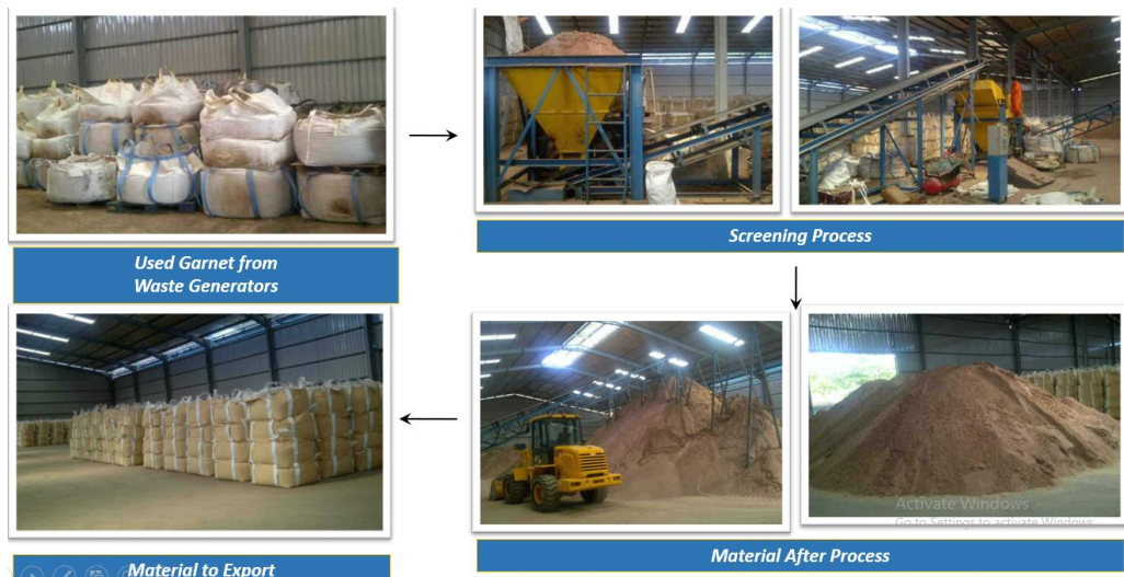
Gambar 4.13 Pengolahan Limbah Padat dengan Screening
