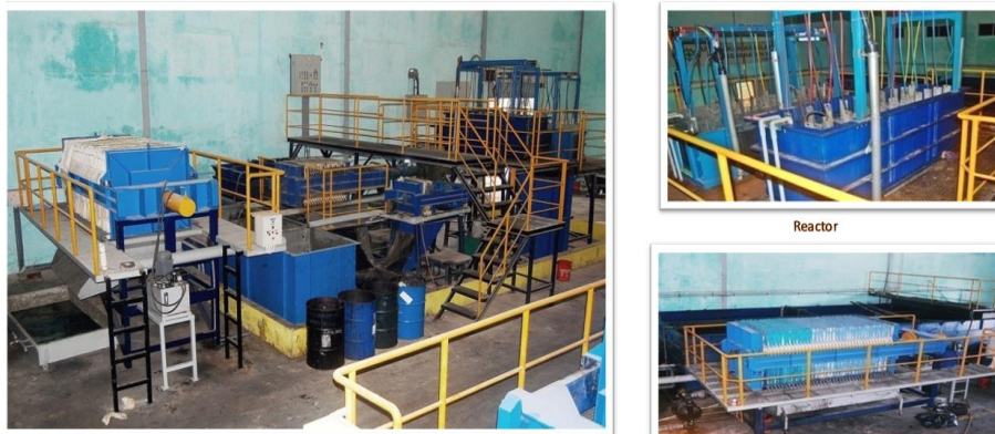
Gambar 4.10 Pengolahan Limbah Cair dengan Electrocoagulant
