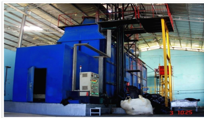
Gambar 4.11 Pengolahan Limbah Padat dengan Incinerator
